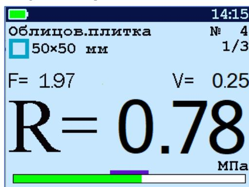
6.6.4 Произвести нагружение пресса до контрольного усилия (прочности) или до отрыва фрагмента.
