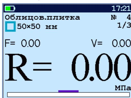
6.6.3 Равномерно вращая рукоятку привода по часовой стрелке, обеспечить скорость нагружения в пределах (200 – 300) Н/с (зеленая полоса должна находиться внутри сиреневых границ).
